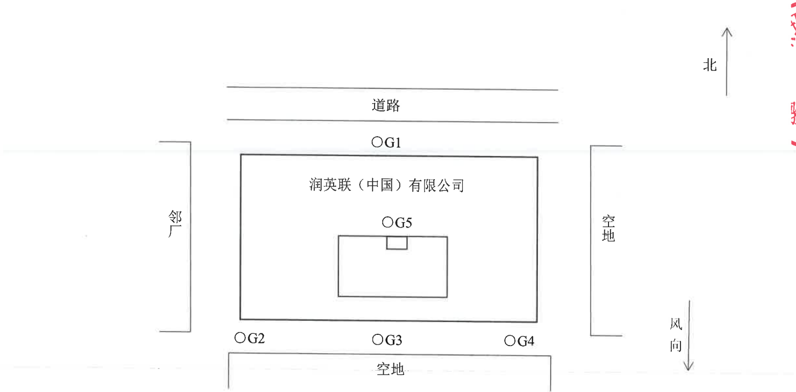
注: OG1~OG5 为无组织废气监测点 图 1: 无组织废气测点示意图 以下空白
